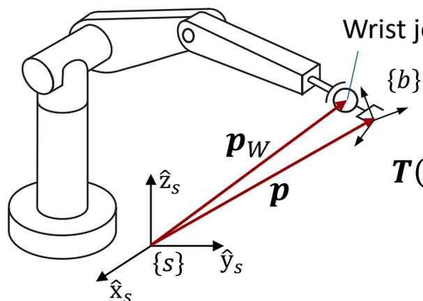
$$T(\theta) = \begin{bmatrix} R_{sb} & \mathbf{p} \\ \mathbf{0} & 1 \end{bmatrix} = e^{[S_1]\theta_1} e^{[S_2]\theta_2} e^{[S_3]\theta_3} e^{[S_4]\theta_4} e^{[S_5]\theta_5} e^{[S_6]\theta_6} M$$
